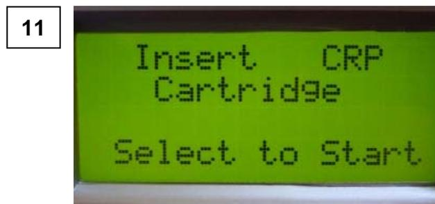
Geben Sie laut Anleitung eine neue Testkassette in den Trägerschlitten und drücken Sie die „Select“-Taste.
