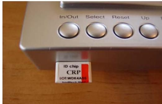
Einsetzen des ID-Chip in den i-CHROMA Reader. Die Lotnummer der verwendeten Testkassette muss mit der Lotnummer des ID-Chips übereinstimmen.
