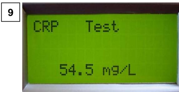
Sie können das Ergebnis am Display ablesen oder den Printerausdruck verwenden. Entfernen Sie die Testkassette aus dem Trägerschlitten.
