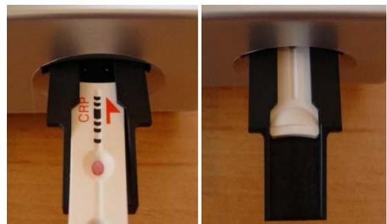
Die Testkassette in den Schlitten des Analyzers geben. Achten Sie darauf, dass der Test bis zum hinteren Anschlag geschoben wird.
